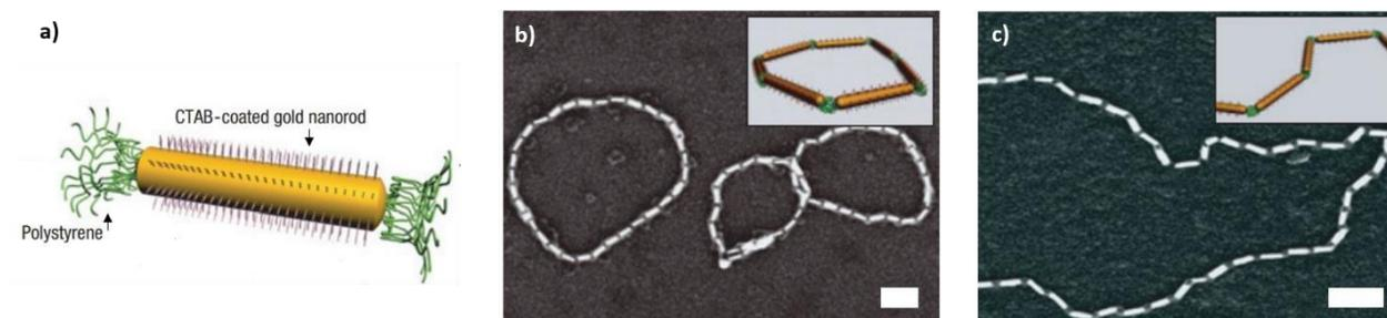
**Figure 60 :** a) Représentation schématique d'un nanobâtonnet d'or amphiphile. Images de MEB de leur auto-assemblage dans un mélange DMF/eau à b) 94/6% volumique et c) 80/20% volumique. Barres d'échelle : 100 nm. Les encarts illustrent le comportement d'assemblage.<sup>5</sup>
