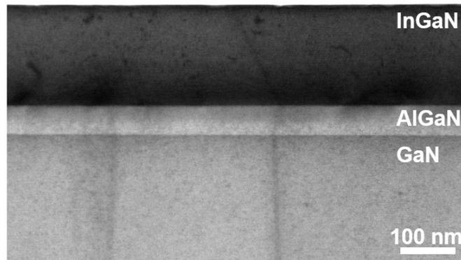
FIGURE 3.32 – Image ADF STEM de l'échantillon  $\text{C}_3$  selon l'axe de zone  $[01\bar{2}0]$ .
