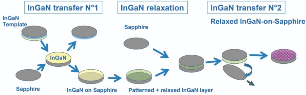
FIGURE 2.3 – Schéma des étapes de la fabrication de substrats InGaNOS [1].
