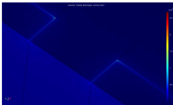
FIGURE 5.4 – Simulation qui montre le champ électrique concentré sur les coins des électrodes avec des bouts carrés.
