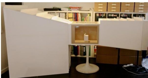
Figure 270. Prototype de tunnel à vent réalisé par D.Serero pour comparer l'échelle des phénomènes
