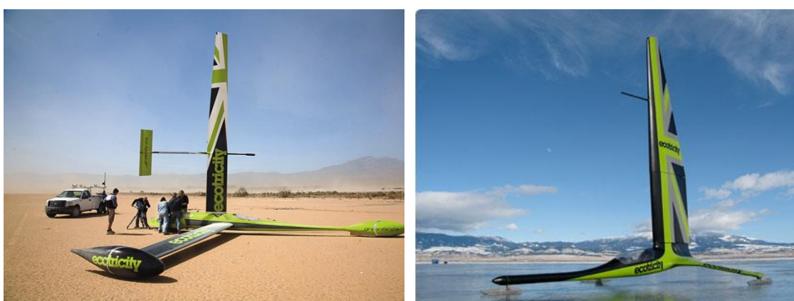
Figure 234. Le Greenbird, voiture propulsée par le vent bat le record de vitesse dans le désert du Nevada à 201\text{ km/h} , piloté par l'anglais Richard Jenkins. Il utilise aussi une voile rigide en carbone de type Foil pour atteindre 3 à 5 fois la vitesse du vent.
