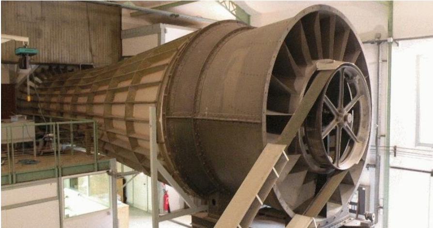
Figure 25. Motorisation de la soufflerie Eiffel, Photo D. Serero du 18/09/2016. Source © Laboratoire Eiffel, avec l'aimable autorisation de Monsieur Martin Peter
