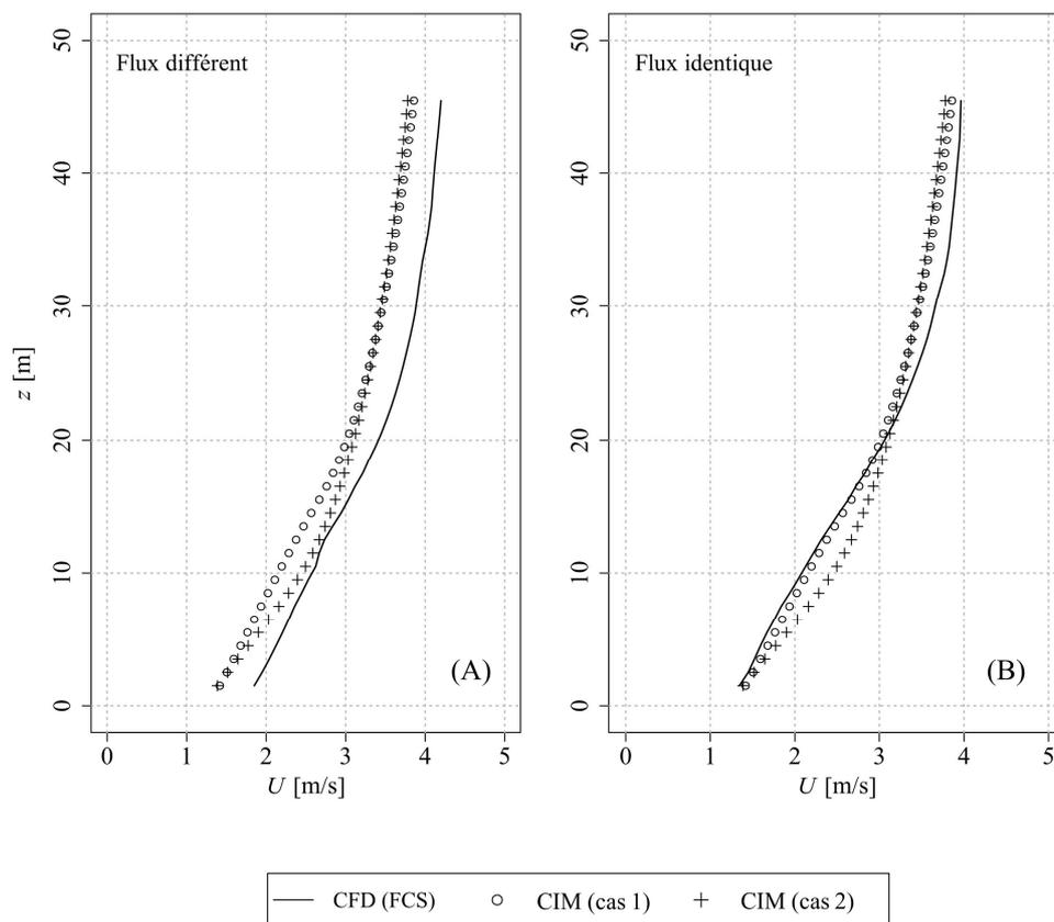
Fig. 2 – Comparaison entre les profils de vitesse obtenus avec la CFD et avec le modèle CIM (à gauche avant égalisation des flux, à droite après égalisation des flux).
