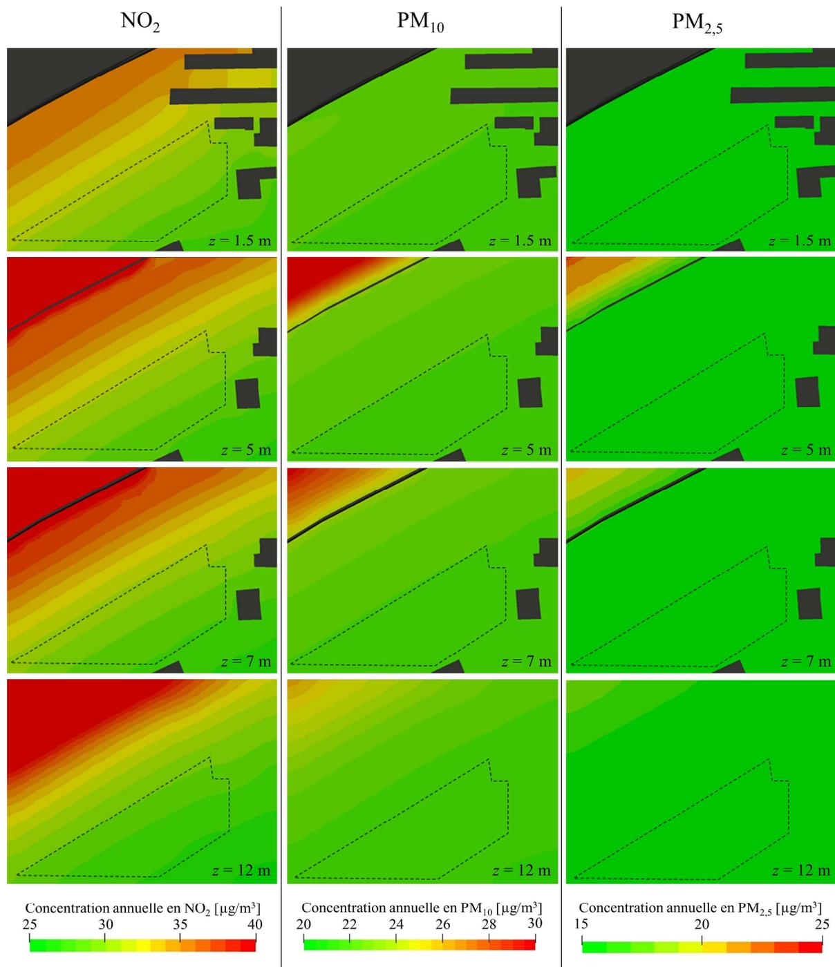
Fig. 21 – Concentration annuelle en  $\text{NO}_2$ ,  $\text{PM}_{10}$  et  $\text{PM}_{2,5}$  modélisées pour différentes altitudes avec la zone prévue pour aménagement délimitée par des traits discontinus.
