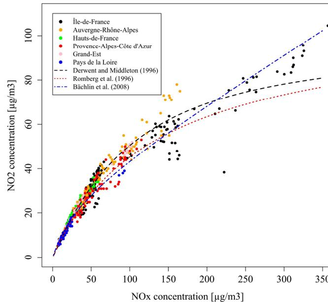
Fig. 13 – Evolution de la concentration en  $NO_2$  en fonction de la concentration en  $NO_x$  et comparaison avec des lois empiriques (Jurado et al., 2020).
