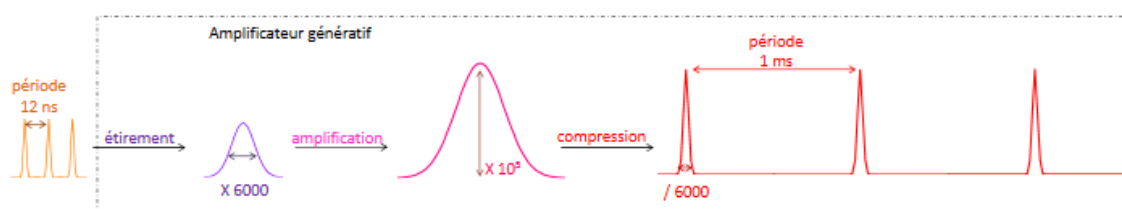
Figure 37 : schéma de principe de l'amplification par amplificateur régénératif des impulsions issues du laser Mira.
