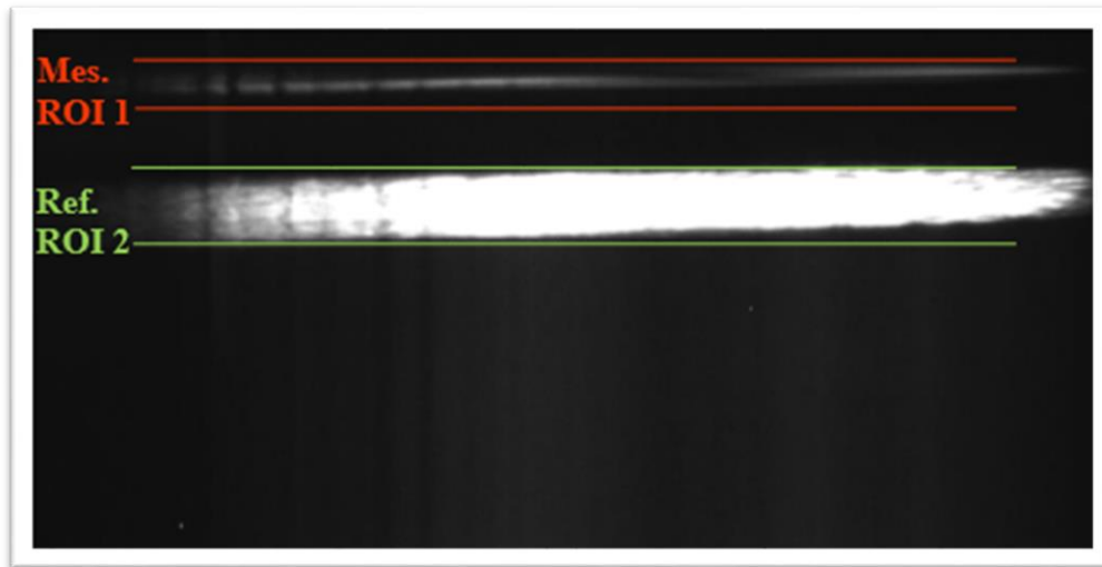
Figure 46 : Affichage des deux signaux SFG sur le détecteur (échantillon et référence) ainsi que leur ROI sur la CCD. L'axe horizontal correspond à la longueur d'onde du spectre SFG.
