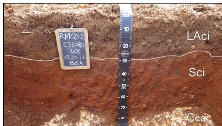
Figure 2-5 : Photographie d'une fosse pédologique sur un site RMQS. Les horizons explicités (LAc1, Sci, Cca) correspondent à un CALCISOL fersiallitique issu de calcaire fissuré, cultivé
