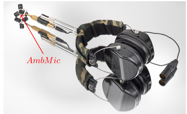
(b) Prototype B avec le microphone ambisonique d'ordre 1. AmbMic dénomme les capsules arrangées tétraédriquement du microphone ambisonique.
