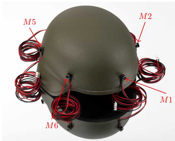
(c) Prototype C avec ses microphones. Les microphones M3 et M4 ne sont ni visibles ni indiqués sur la figure.
