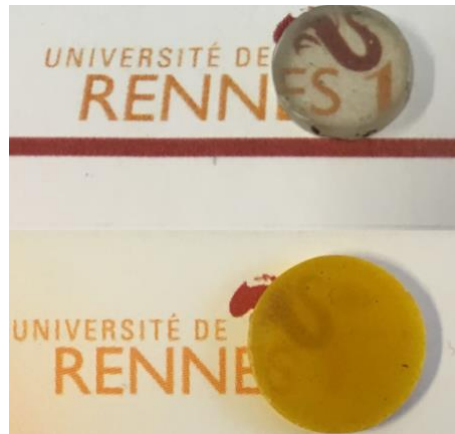
Fig. 11. Photo du verre \text{LiS25PS} (en haut) et du verre hybride dopé avec l'OPSC (en bas)
