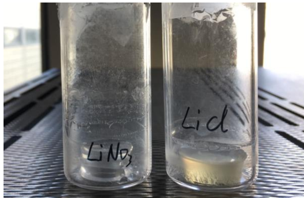
Fig. 7. Photographie du xérogel TEOS- \text{LiNO}_3 et TEOS- \text{LiCl}
