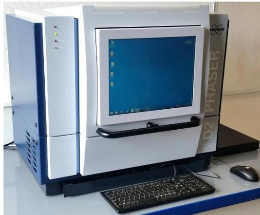
*Figure III.15 : Diffractomètre Bruker D2 Phaser (SATIE - ENS Paris-Saclay).*
