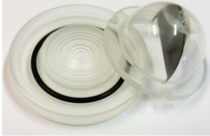
*Figure III.16 : Dôme transparent avec couteau anti-diffusion.*
