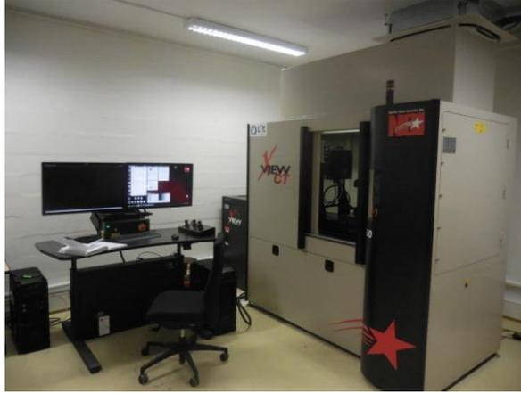
*Figure II.9 : Micro-tomographe X50 (LMT).*
