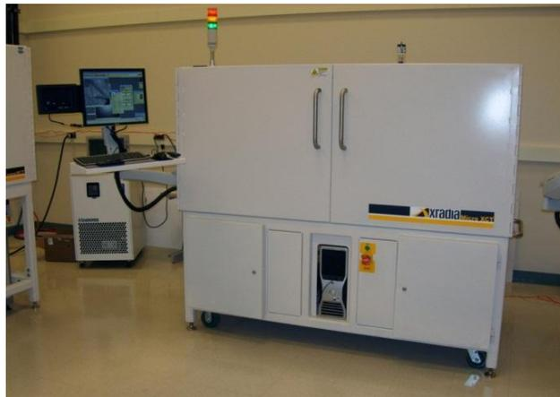
*Figure II.2 : Micro-tomographe MicroXCT-400 (CEREGE).*
