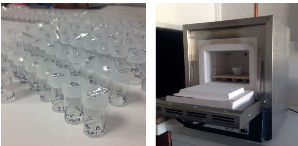
Figure C2.III.1-6) Photo de échantillons de bois avec aluminium (gauche) et du four à moufle (à droite).
