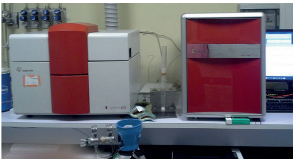
Figure C2.II-1) Photos de l'instrumentation, avec un couplage d'un analyseur élémentaire et d'un spectromètre de masse à rapport Isotopique (EA-IRMS, LOV - UMR 7093, Villefranche sur Mer).
