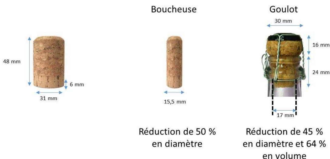
Figure 13 : Changements structuraux d'un bouchon A2R au sein de la boucheuse et du goulot. Les valeurs dimensionnelle pour la tête du bouchon (hors goulot) après bouchage est une moyenne obtenue par mesure au pied à coulisse.
