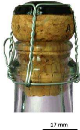
Figure 57 : Echantillon utilisé pour évaluer la diminution de porosité du bouchon inséré dans un goulot par pycnométrie à l'hélium.
