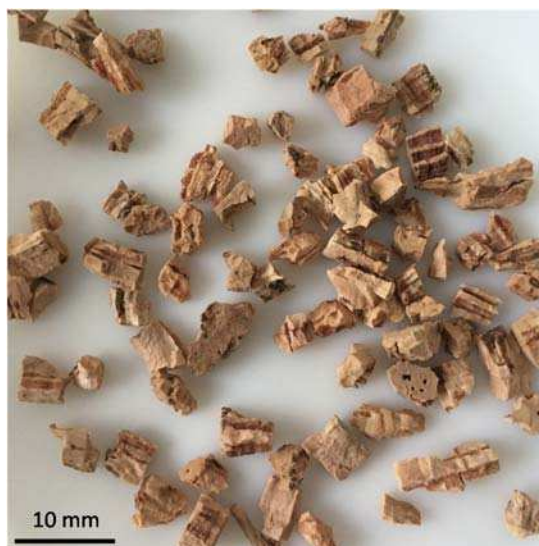
Figure 50 : Macro-granulés obtenus après trituration du liège et utilisés pour la fabrication des manches agglomérés.
