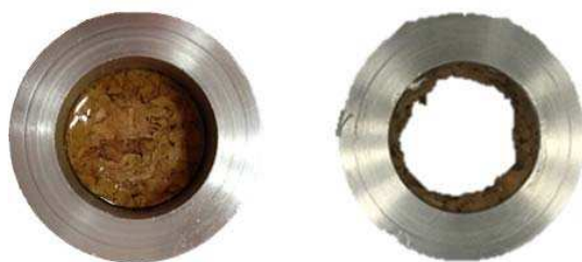
Figure 107 : Echantillon de liège aggloméré avant vieillissement (photo de gauche) et après vieillissement au contact de vapeur de vin modèle pendant 12 mois à 50 °C (photo de droite), après avoir appliqué 0,65 MPa de pression sur les deux échantillons. Ce phénomène est également apparu pour les échantillons vieillis en contact de vapeur d'eau et de vin liquide à 50 °C.
