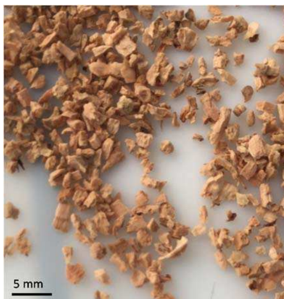
Figure 53 : Micro-granulés obtenus après trituration du liège et utilisés pour la fabrication des manches agglomérés.
