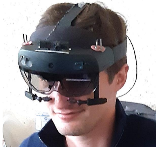
Figure 40 - Photographie des deux caméras de l'eye tracker Pupil Labs intégrées au Microsoft HoloLens 2.
