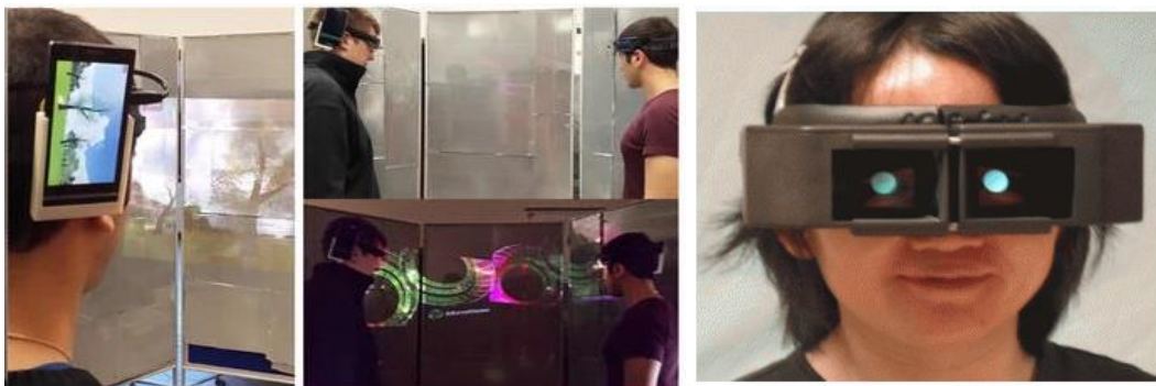
Figure 8 - Exemple de systèmes de RA projectifs portés sur la tête (Hua & Gao, 2007; Kade et al., 2015).
