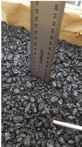
II.4a Vérification de l'épaisseur de la couche du mélange foisonné
