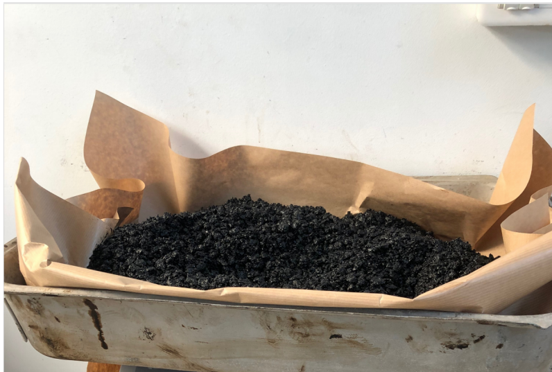
Figure II.3 – Aspect visuel d'un enrobé sortant du malaxeur
