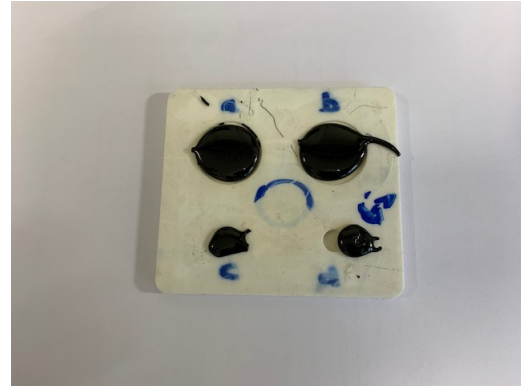
II.22b Pastilles de liant dans le moule silicone
