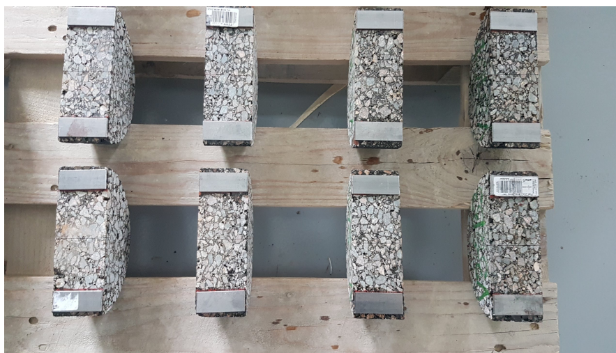
Figure II.40 – Échantillon d'éprouvettes semi-circulaires entaillées prêtes à être testées
