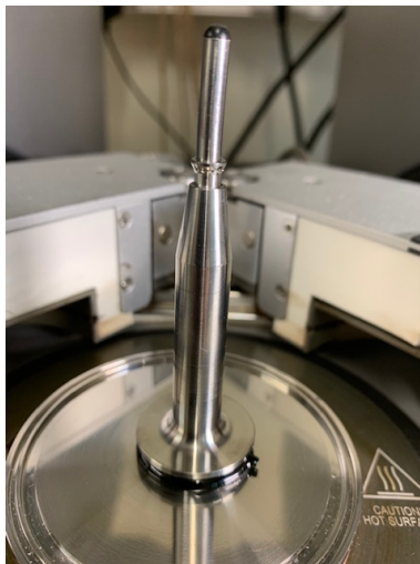
II.23a Chargement de l'échantillon sur la géométrie de 25 mm
