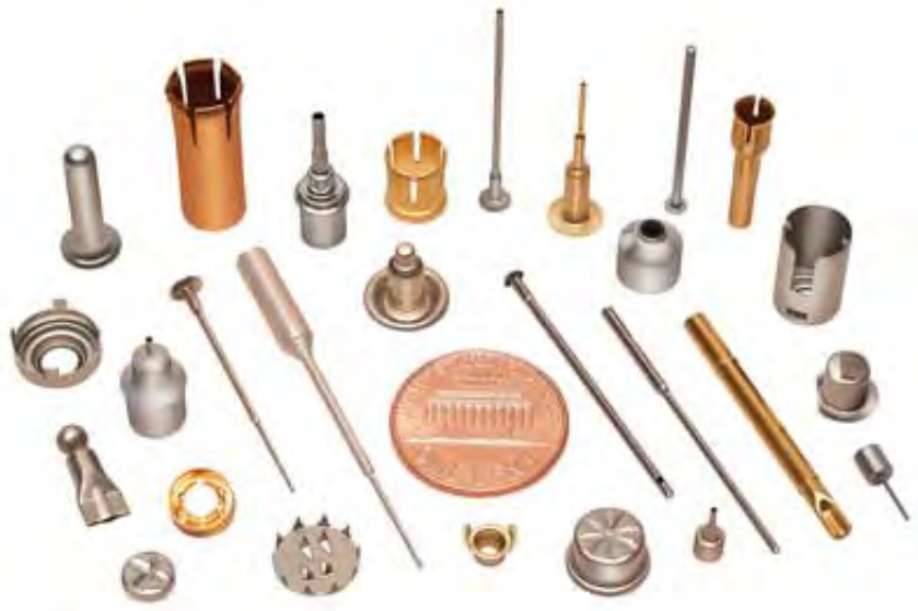
FIGURE 2 – Exemples de pièces miniatures issues de divers procédés de micro-formage [1]
