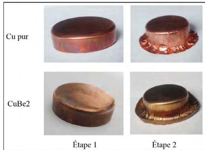
FIGURE 5.2 – Godets en Cu pur et en alliage CuBe2 emboutis après les deux étapes d'emboutissage
