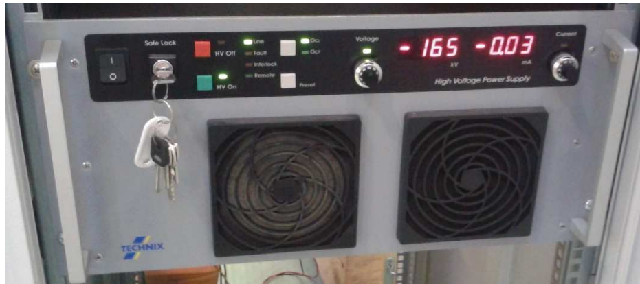
Figure 36 : Photographie de la face avant de l'alimentation haute-tension (polarité négative).
