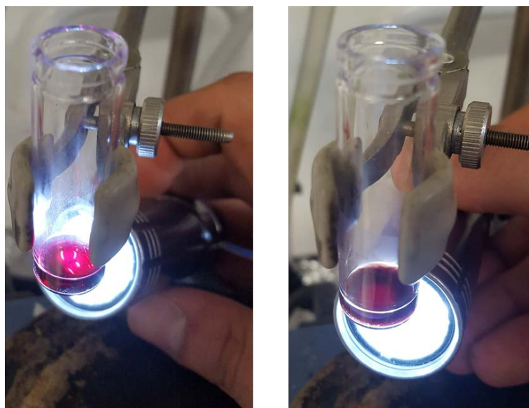
Figure 130. Solution de [\text{Ag}_4\text{C}](\text{BARF})_4 dans DCM avant (à gauche) et après (à droite) ajout d'un excès de \text{TBAPF}_6 .
