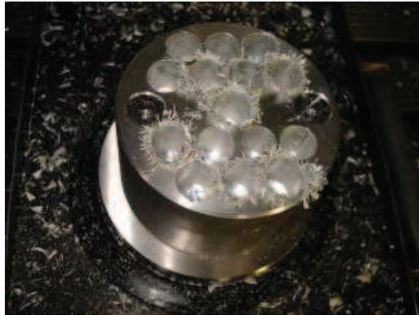
*Figure IV.21. Qualité de la surface après usinage dans l'aluminium AU4G avec un foret Tivoly 388 revêtu ZrN*
