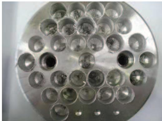
**Figure IV.24. La qualité de la surface après l'usinage dans l'aluminium AS10 traitement thermique**
