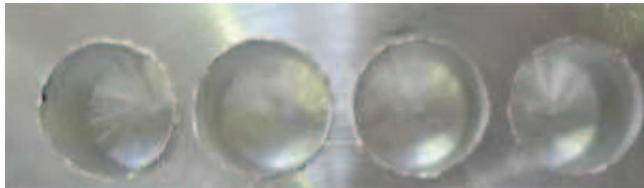
**Figure IV.28. Surface après usinage dans l'aluminium AU4G avec un foret Tivoly 14007 revêtu ZrN**
