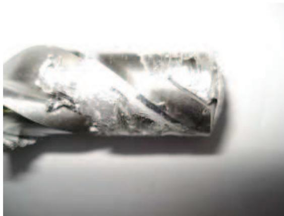
*Figure IV.26. Phénomène de collage pendant l'usinage de l'aluminium AS7 avec des vitesses de rotation élevées*
