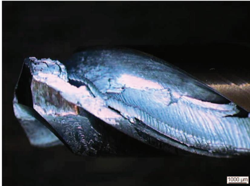
**Figure IV.37. Phénomène de collage pendant l'utilisation du foret carbure dans l'aluminium AS7 avec une avance de 0,05mm/tr et une vitesse de rotation de 5000tr/min**
