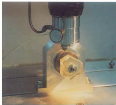
*Figure I.6. Utilisation des vibrations ultrasoniques*
