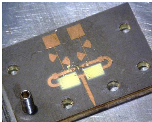
Figure 3-66 : Photographie du circuit avec dépôt de la couche active
