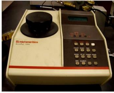
Figure III.7. Pycnomètre à hélium pour la mesure de masse volumique.
