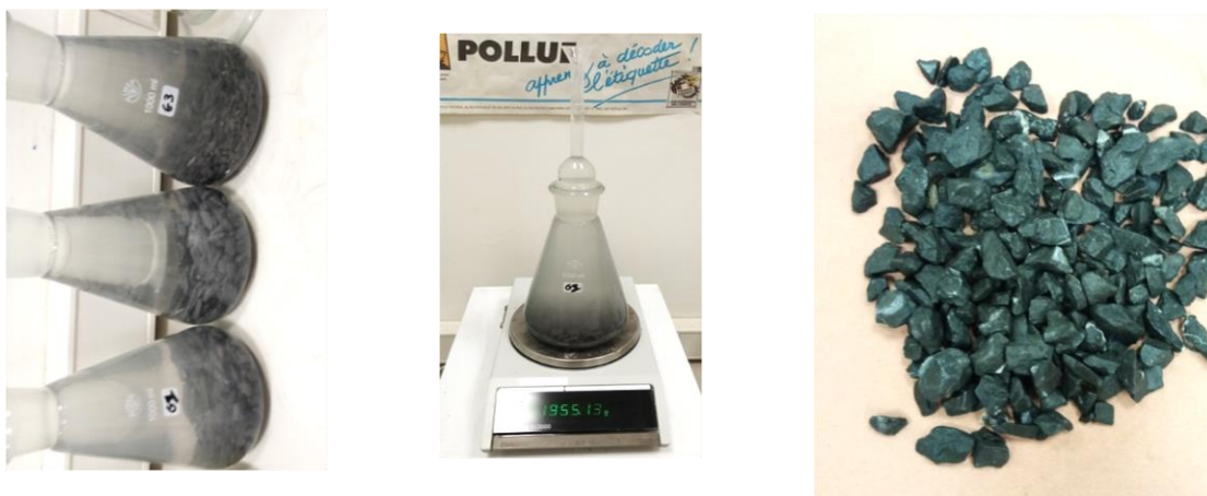
Figure IV.4. Détermination de l'absorption des granulats avec la méthode du pycnomètre.
