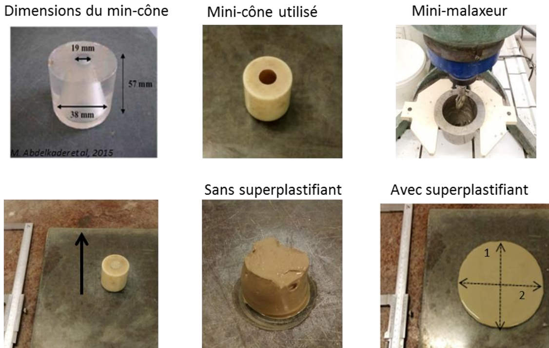
Figure IV.8. Mesure de l'étalement à l'aide du mini-cône.
