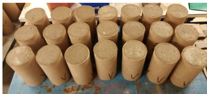
Figure VI.2. Éprouvettes cylindriques de bétons 11×16 cm.
