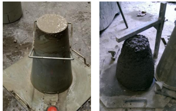
Figure IV.18. Essai d'affaissement au cône d'Abrams.
