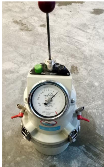
Figure IV.19. Mesure de la teneur en air occlus des bétons.
