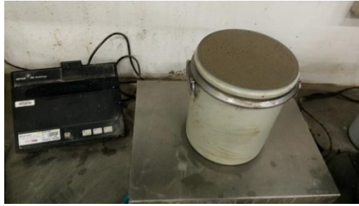
Figure IV.17. Mesure de la masse volumique du béton.
