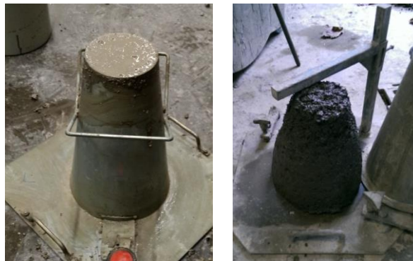
Figure IV.18. Essai d'affaissement au cône d'Abrams.
