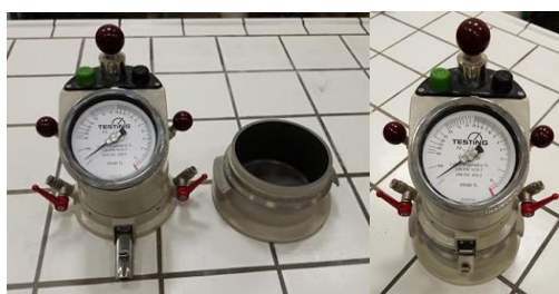
Figure V.25. Manomètre pour la mesure de la teneur en air occlus des mortiers.
