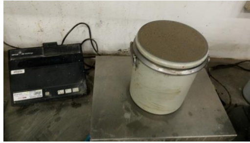
Figure IV.17. Mesure de la masse volumique du béton.
