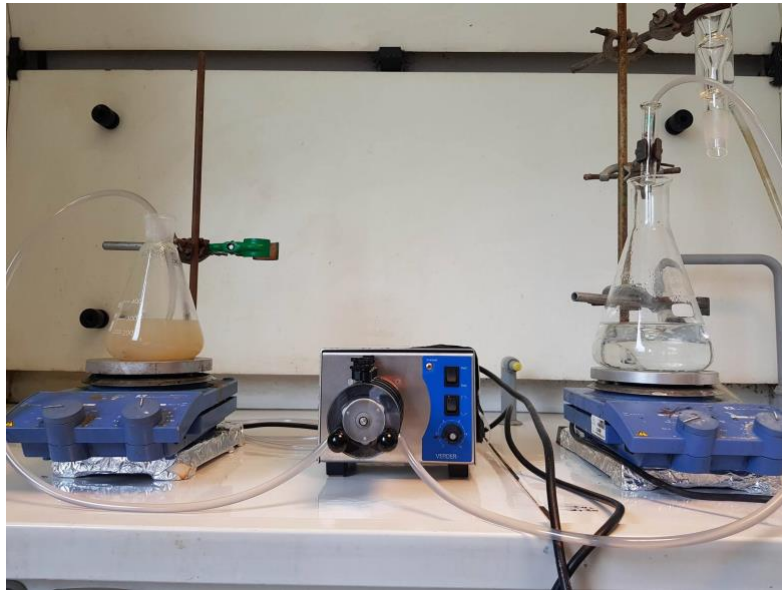
Figure 74: billes à base de biopolymère formées par extrusion d'alginate
