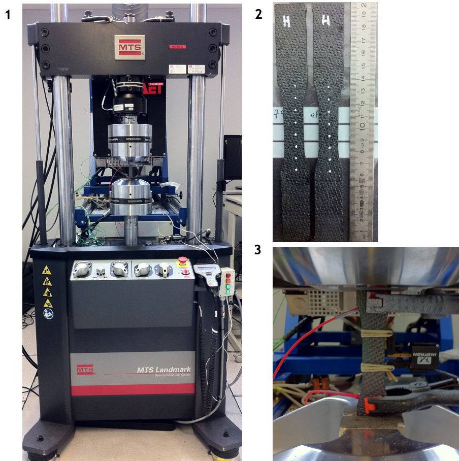
Figure A.6.1 : Photographies de 1) l'appareil de traction des CMCs à température ambiante, 2) des éprouvettes utilisées puis 3) positionnées dans le mord avec l'extensiomètre.
