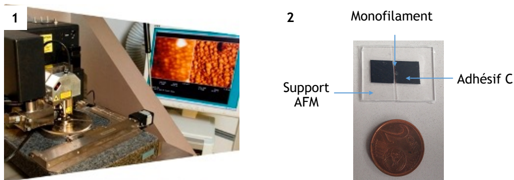
Figure II.3.7 : Photographies 1) de l'appareil AFM et 2) du support utilisé pour réaliser l'analyse de la surface d'un monofilament.
