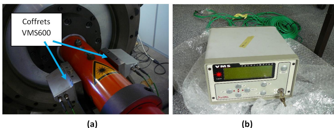
Figure 229 : Photographies du lanceur TITAN et du dispositif de mesure de vitesse de projectile VMS600
