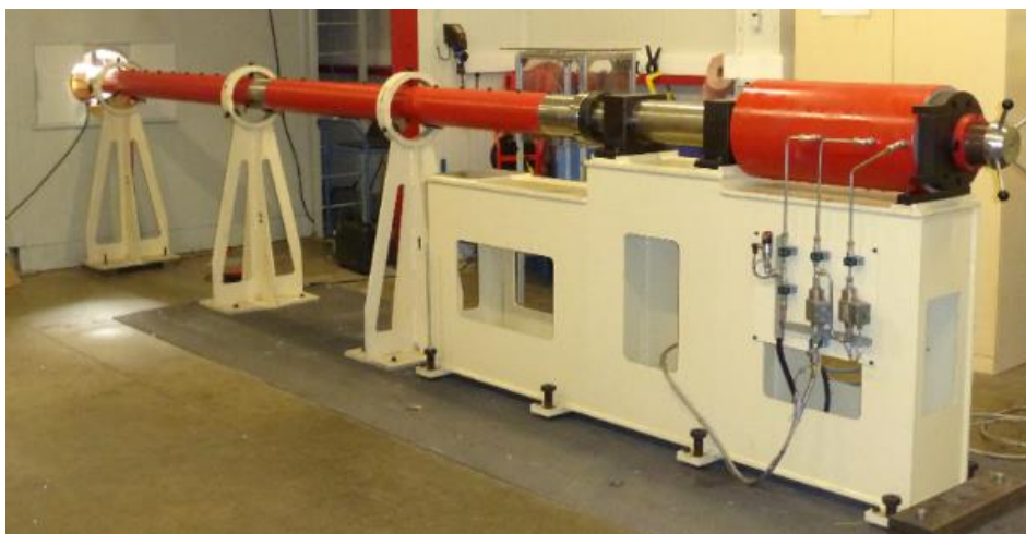
Figure 228 : Lanceur à gaz pneumatique simple étage THOR en version 140 mm
