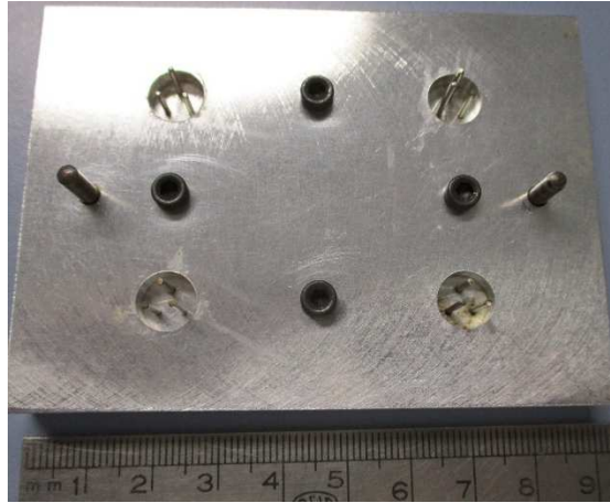
Figure III-11. Nouveau moule pour la fabrication des plots triples, fabriqué dans l'atelier de mécanique du laboratoire.
