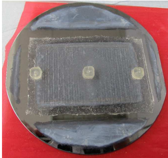
Figure III-4. Puce microfluidique rectangulaire et plots collés sur wafer contenant des nanofils.
