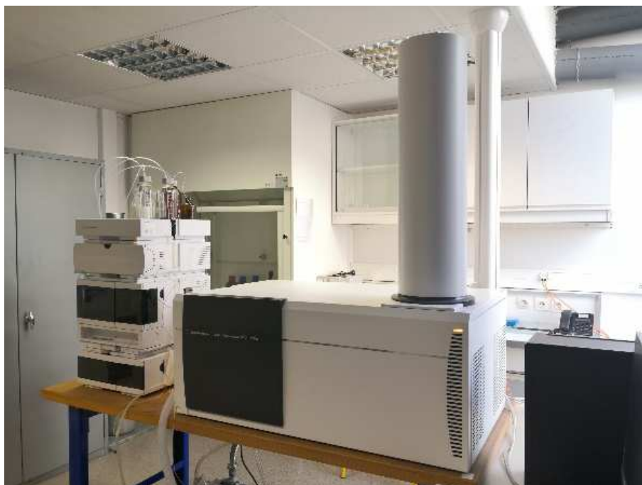
Figure II-2. Dispositif HPLC/MS utilisé au laboratoire. La HPLC est située à gauche, et le spectre de masse à droite.
