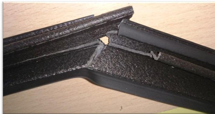
**Figure 5-8 Rupture fragile d'un profilé polypropylène/fibre de bois lors d'une découpe en ligne**
