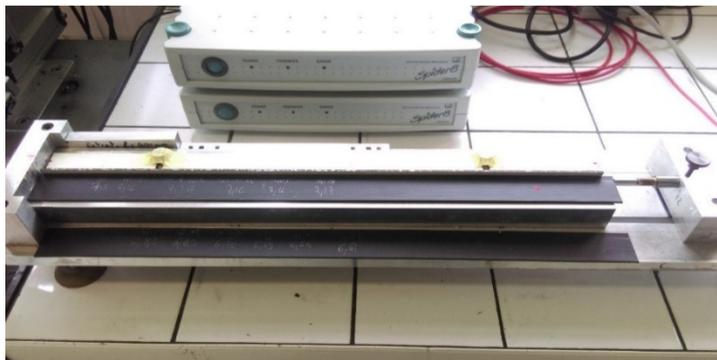
**Figure 2-12 Banc de mesure pour le retrait longitudinal**
