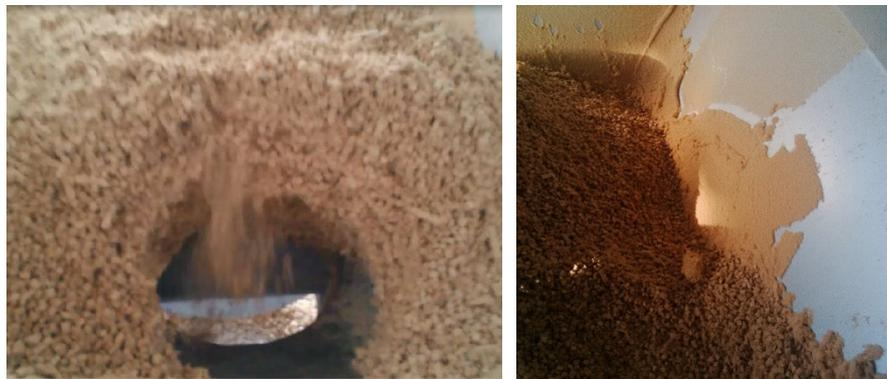
**Figure 5-5 Formation d'un dôme de granulés de fibres de bois et poussières sur les parois du doseur**
