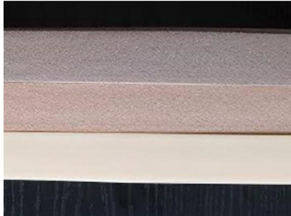
**Figure 4-3 Bandes plates extrudées ( de bas en haut : PP/lin, PP/bois et PP/cellulose).**
