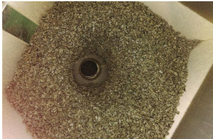
**Figure 5-19 Mauvais écoulement des granulés PP/bois dans la trémie de l'extrudeuse monovis.**
