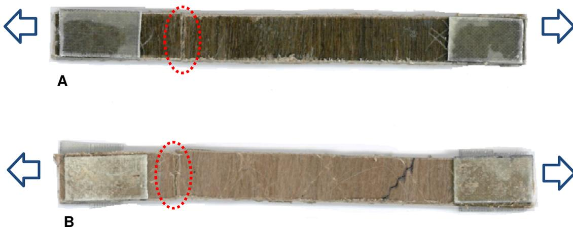
Figure 6-17 Facies de rupture des composites unidirectionnel sollicités en traction transverse et renforcés par des fibres de lin (A) et des fibres de jute (B)
