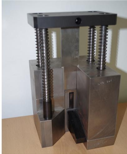
Figure 2-9 Moyen de découpe de laboratoire développé par Cooper Standard
