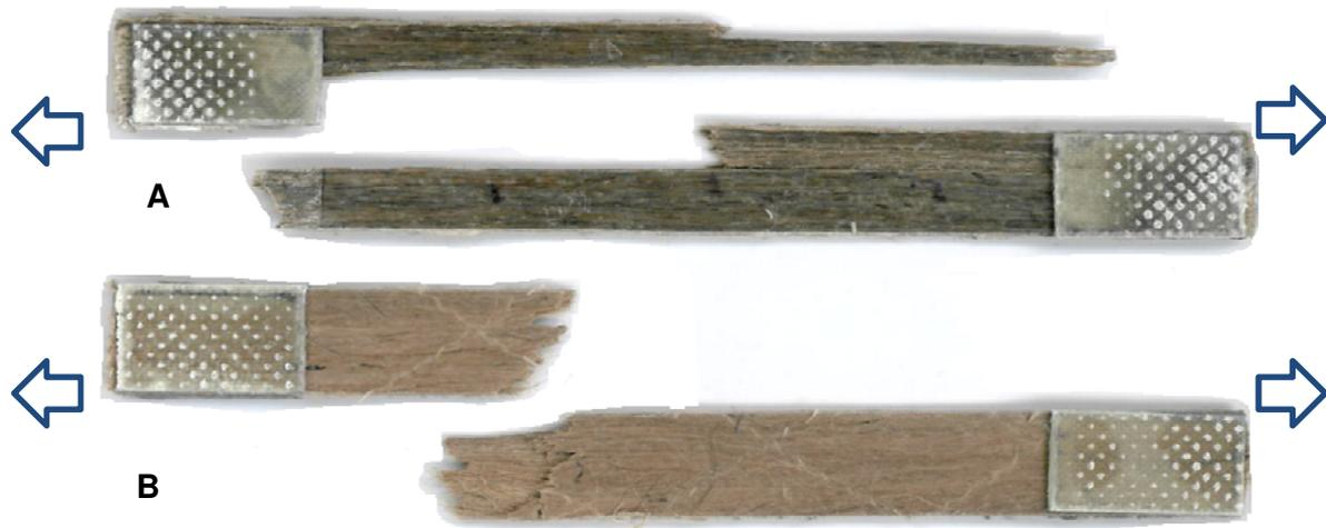
**Figure 6-11 Facies de rupture des composites unidirectionnel sollicités en traction longitudinale et renforcés par des fibres de lin (A) et des fibres de jute (B)**
