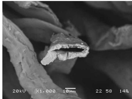
**Figure 3-11 Section de fibre de bois au sein d'un granulé Woodforce®.**
