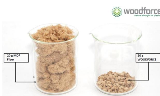
**Figure 3-9** Volume occupé par 20 g de fibres de bois pour MDF et de granulés Woodforce®
