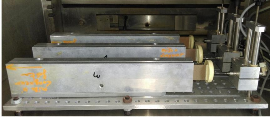
**Figure 2-13** Banc de mesure de dilatation thermique des bandes extrudées
