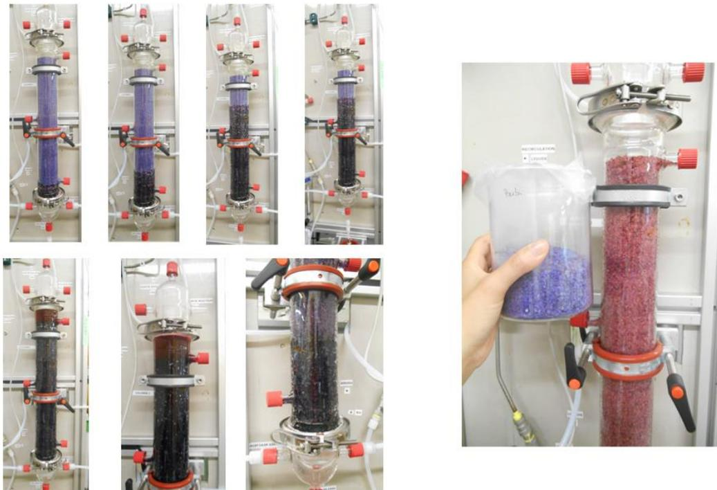
**Figure III.3.** Mouillage du catalyseur (Etape NC2)
