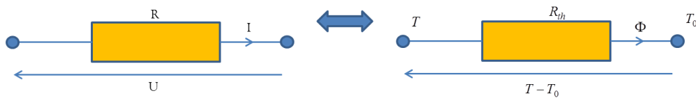
Figure 2.22 : Analogie entre résistances électrique et thermique
