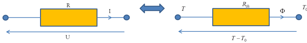
Figure 2.22 : Analogie entre résistances électrique et thermique
