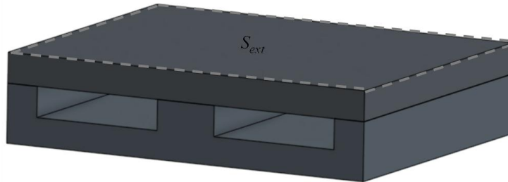
(a) Vue 3D d'un noyau magnétique
