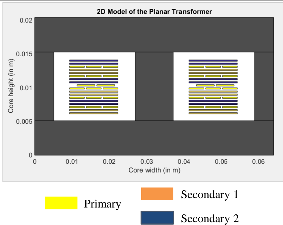
Figure 4.15 : Description des conducteurs du transformateur TAB
