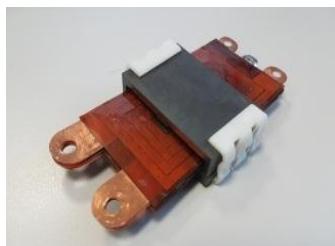
Figure 1.18 : Transformateur planar avec des enroulements de type feuillard 8 couches
