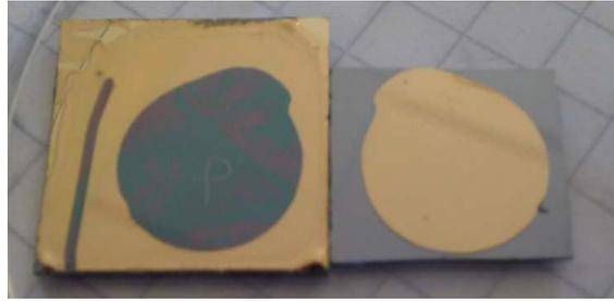
Figure 46 - Photo du moule de PMMA recouvert d'or après transfert (à gauche) et du film d'or nanostructuré sur un substrat de silicium (à droite)
