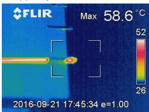
(b) Observation à la caméra thermique du collimateur. Puissance incidente : 21 W.
