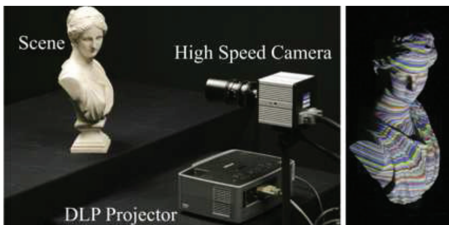
FIGURE 2.16: Exemple de système de suivi avec lumière structurée [NKY08].
