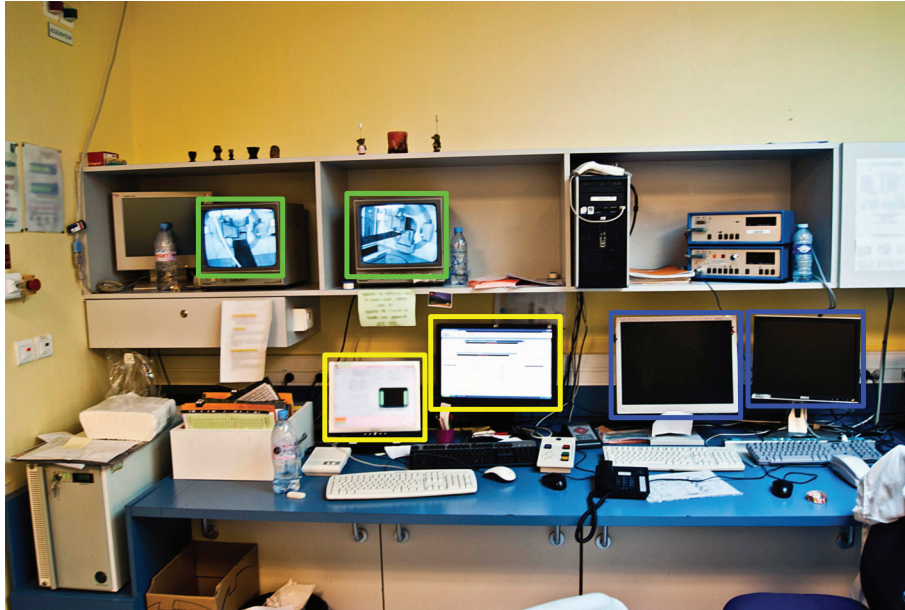
FIGURE 1.4: Exemple de poste de contrôle d'une salle de traitement (Centre Léon Bérard à Lyon [7]). On remarque principalement dans cette image que le manipulateur doit travailler avec plusieurs écrans pendant le traitement. Vert : écrans connectés aux caméras à l'intérieur de la salle. Jaune : système d'information, de contrôle ( Record and Verify ), et de pilotage des machines. Blue : autres systèmes pour le positionnement du patient (partie logicielle).
