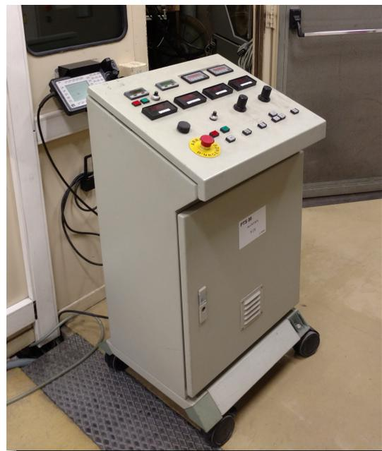
FIGURE 1.12 – Pupitre de commande du système de projection arc-fil Tafa du LERMPS
