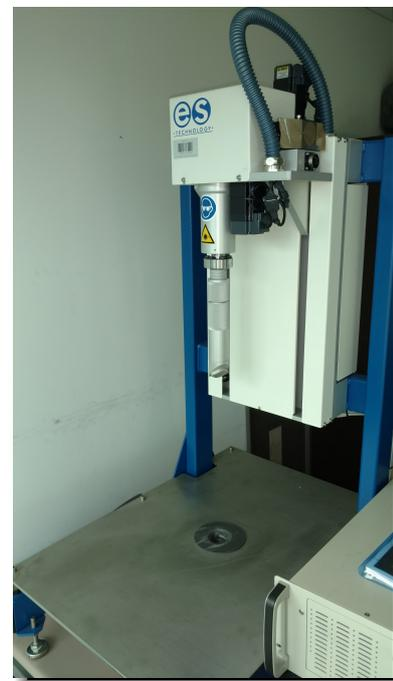
FIGURE 5.3 – Dispositif LASER pour préparation de surfaces sur la paroi interne de cylindres
