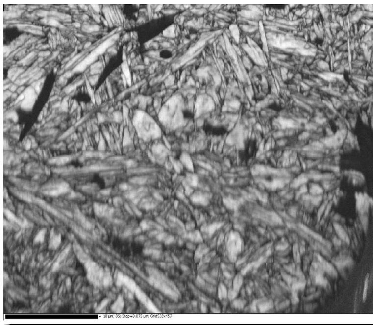
FIGURE 3.38 – Cartographie de Band Slope de la zone analysée par EBSD à proximité de la surface
