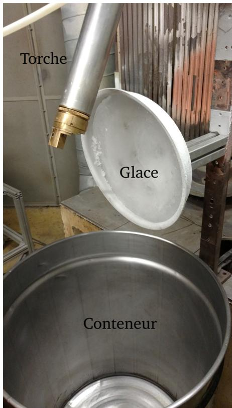
FIGURE 2.10 – Montage réalisé pour la collecte de particules au moyen de glace
