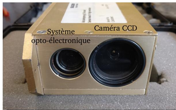
FIGURE 4.6 – Photographie de la tête de détection de l'Accuraspray G3 (TECNAR, Saint-Bruno, Canada)
