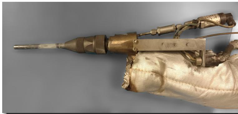
FIGURE 1.8 – Exemple de buse d'un système de projection Cold Spray
