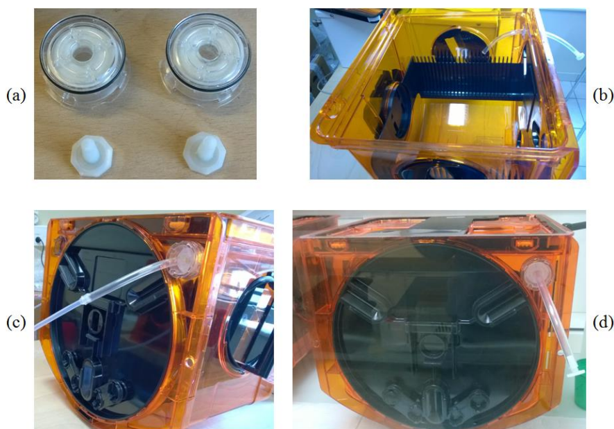
Figure 119 : FOUP et matériel pour la contamination au HF : (a) Filtres percés et bouchons, (b) tuyau communicant, (c) phase de prélèvement tuyau branché et (d) phase d'attente tuyau bouché
