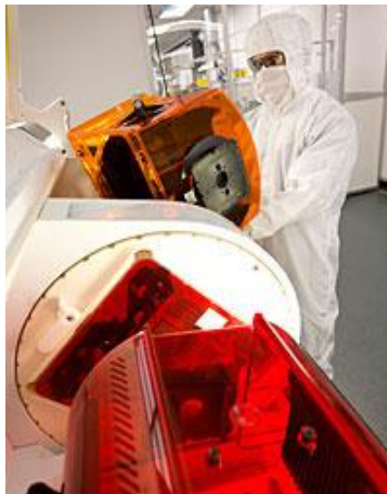
Figure 4 : Prise en charge automatique ou manuelle des FOUPs
