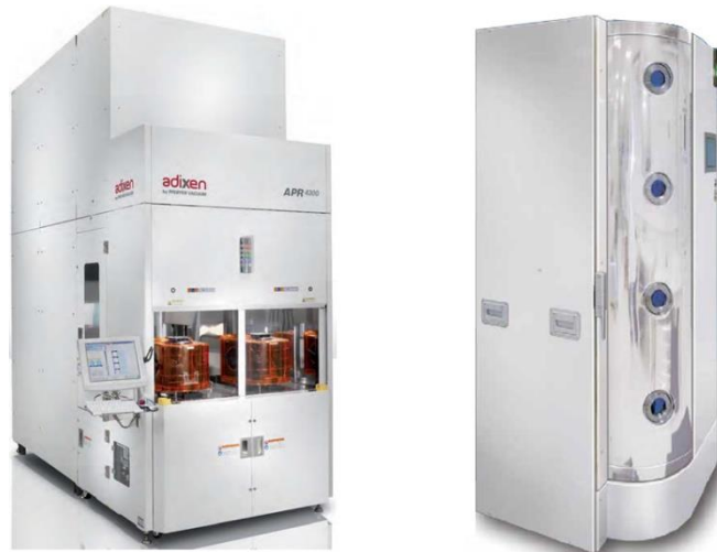
Figure 8 : Systèmes de décontamination adixen : APR 4300 à gauche et AUD à droite
