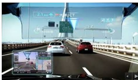
FIGURE 3 – Système de visualisation de réalité augmentée a tête haute (HUD)
