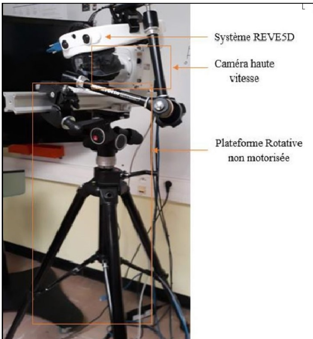
FIGURE 4.10 – Dispositif utilisé pour mesurer la latence
