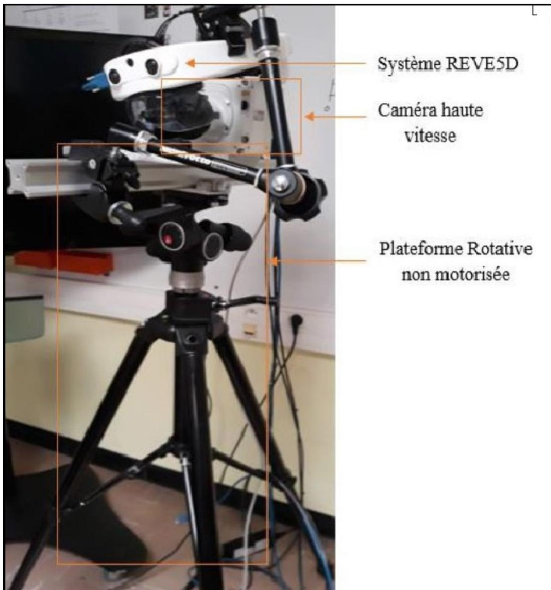
FIGURE 4.10 – Dispositif utilisé pour mesurer la latence
