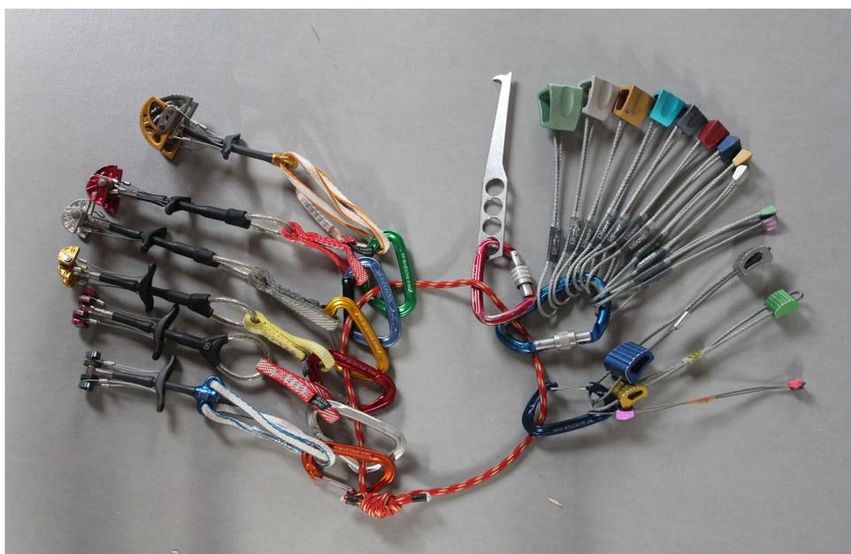
**Figure 1.5.** Coinces mécaniques (à gauche) et coinces câblés (à droite).
