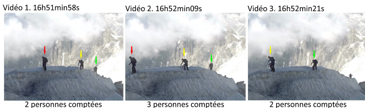
Figure 8.10. Une cordée de 3 personnes remonte très lentement l'arête de l'aiguille du Midi et déclenche trois fois de suite l'enregistrement d'une vidéo, à 12 secondes d'intervalle. Au total, le logiciel comptabilise 7 passages différents au lieu de 3.
