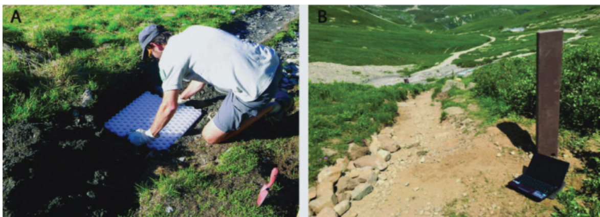
Figure 1 - Deux capteurs capables de mesurer la fréquentation de sentiers de montagne. A) Mise en place d'un capteur Dalle (photo V. Fourcaudot). B) Capteur Pyro (photo G. Garcel).
