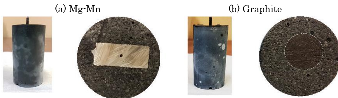
Figure 4-17 : Photos des échantillons de (a) Mg-Mn et (b) graphite après 28 jours de couplage galvanique en milieu désaéré.
