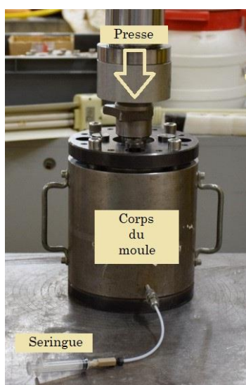
Figure 2 -3 : Poste d'extraction de la solution porale.
