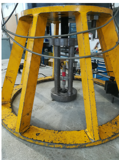
FIGURE 4.7 – Montage final utilisé pour le test d'arrachement d'un goujon M20*160.
