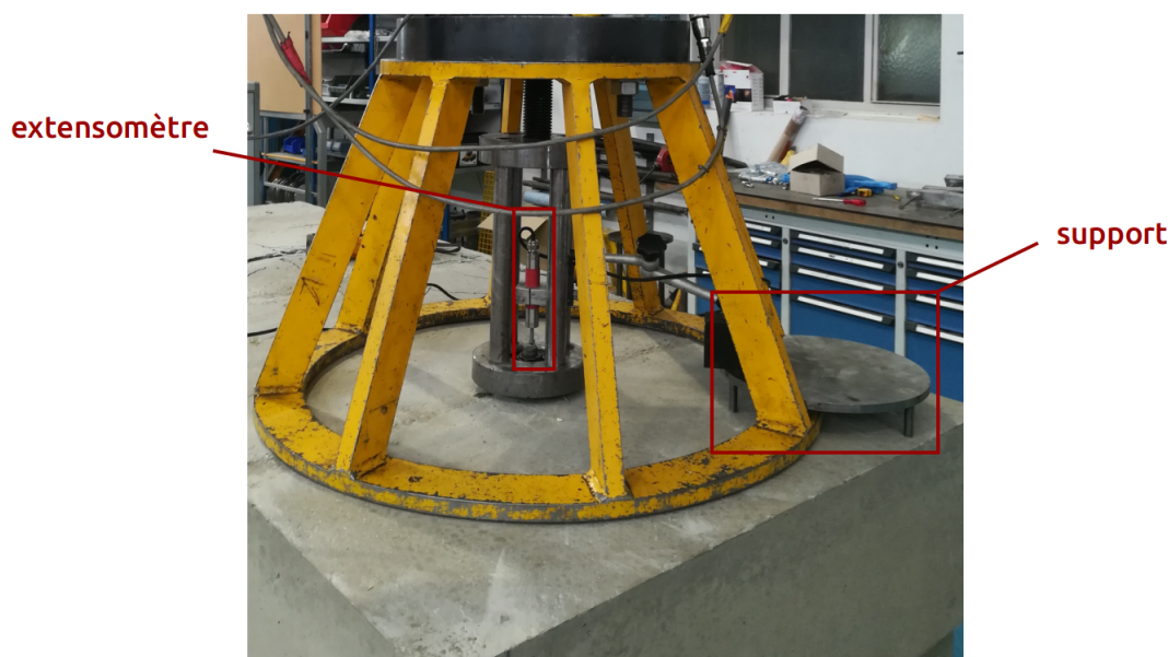
FIGURE 4.32 – Position du capteur de déplacement constitué d'un extensomètre et son support.
