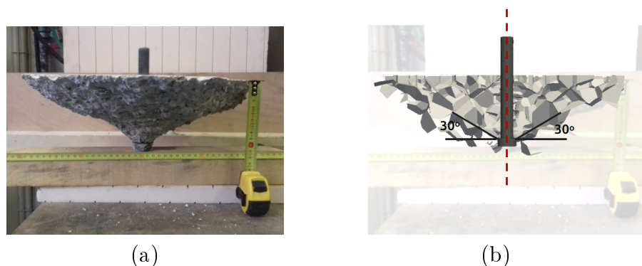
FIGURE 4.35 – Cône de béton arraché (a) expérimentalement (b) numériquement.
