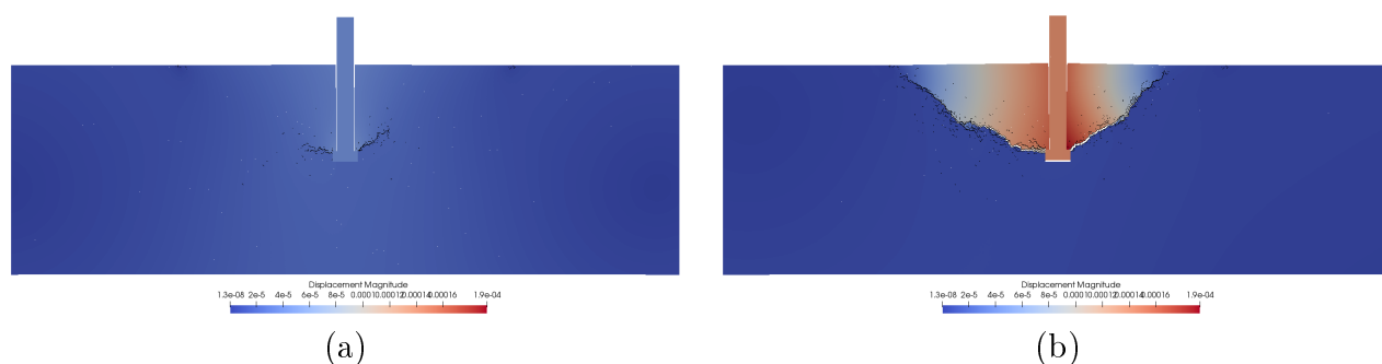
FIGURE 4.14 – Champs de déplacement et faciès de fissuration obtenus lors d’un test d’arrachement à un déplacement égal à (a) 3,6 \cdot 10^{-5} m (b) 1,4 \cdot 10^{-4} m.
