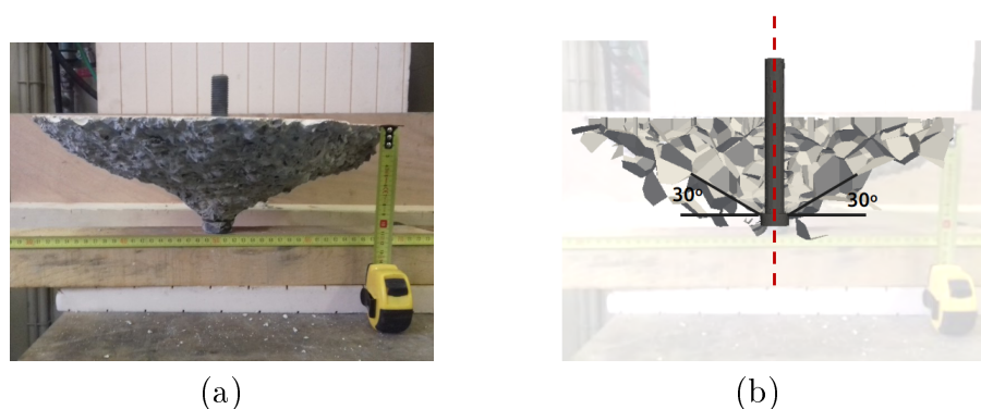
FIGURE 4.35 – Cône de béton arraché (a) expérimentalement (b) numériquement.
