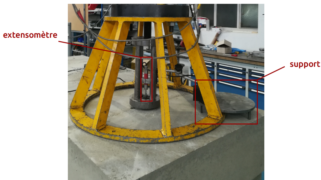
FIGURE 4.32 – Position du capteur de déplacement constitué d'un extensomètre et son support.
