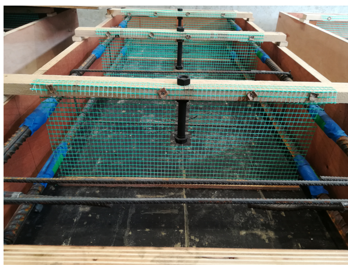
FIGURE 4.5 – Treillis de fibre de verre traversant l'ancrage.
