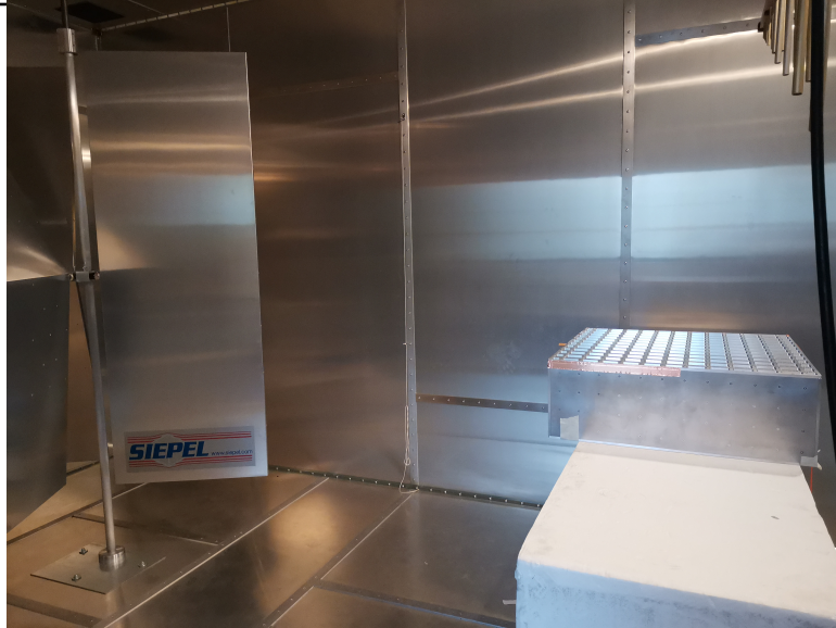
FIGURE III.12 – Dispositif en CRBM
