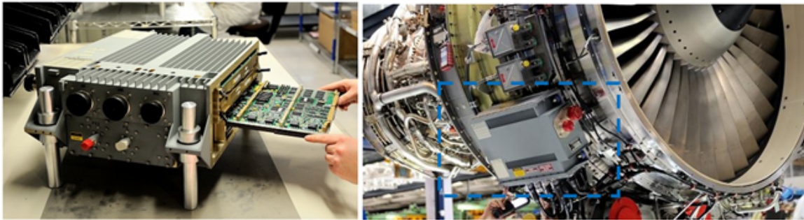
(a) Montage de cartes sur FADEC @Safran® (b) Localisation du FADEC sur nacelle @Safran®
