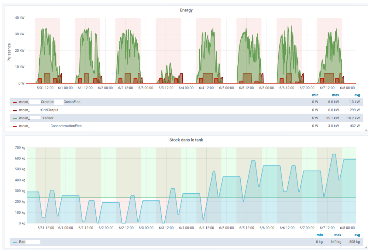
FIGURE 8.5 – Suivi dans la plateforme dédiée, le graphique en haut représente les flux d'énergie électrique et celui de bas l'état de charge du moyen de stockage au cours du temps. La production d'énergie est en vert, la consommation teinte de rouge. La ligne verte correspond à un seuil de sécurité que le système essaie de maintenir.
