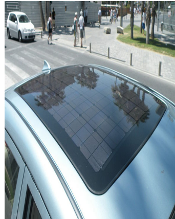
(b) Toit de voiture intégrant des cellules photovoltaïques
