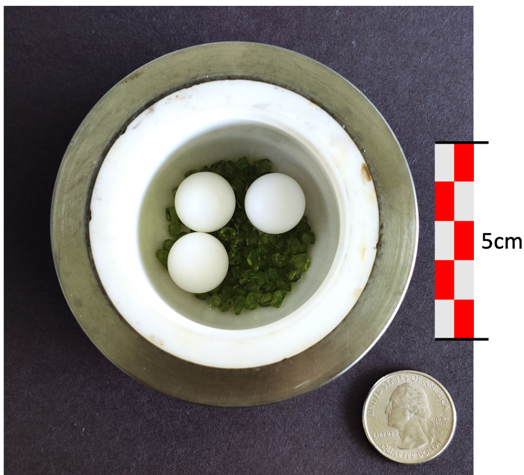
FIGURE II.4 – Photographie du bol de broyage en ZrO_2 du broyeur planétaire PM100, avec les billes de broyages de 1.5 cm de diamètre et des cristaux millimétriques d'olivine.
