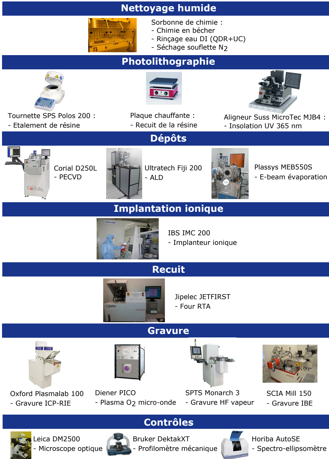
FIGURE 6.1 – Liste des équipements nécessaires à la fabrication des diodes à la PTA, regroupés par secteur.
