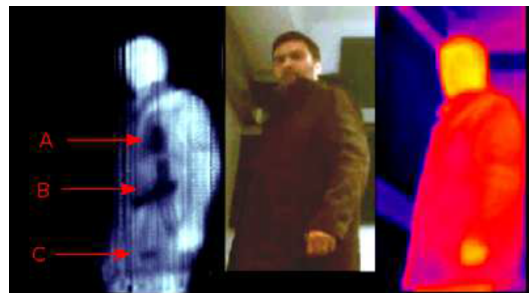
FIGURE 1.9 – Panel photographique illustrant l'intérêt de l'imagerie sub-THz, photographie de gauche, pour la détection d'objets cachés par rapport à l'imagerie visible au centre ou infrarouge à droite (A : un portefeuille, B : un pistolet à air, C : de la monnaie), extrait de [28]
