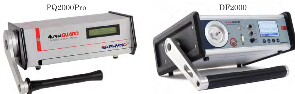
Figure 3.3 – Moniteurs de radon AlphaGUARD® utilisés dans cette expérience.
