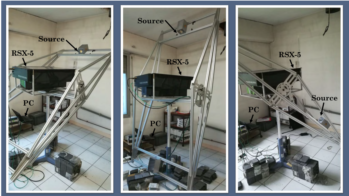
Figure 2.14 – Exemples de mesures de calibration en efficacité de détection réalisées au cours du mois de février 2019. Ces photographies présentent le système mécanique ainsi que le protocole mis en place pour l’acquisition. Les blocs de plomb disposés au sol assurent la stabilité.
