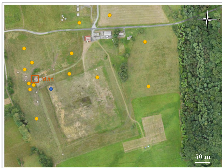
Figure 4.20 – Orthophotographie du site P2OA-CRA de résolution 50 cm. La tour instrumentée est marquée par un cadre rouge. Les cercles représentent les zones de mesure de la densité apparente du sol. Les cercles jaunes ont une gamme de valeur similaires y compris sur la mesure de répétabilité (environ 1,20 \text{ g.cm}^{-3} ). Le cercle bleu montre une densité apparente supérieure ( 1,50 \text{ g.cm}^{-3} ). Crédit : Solène Derrien.
