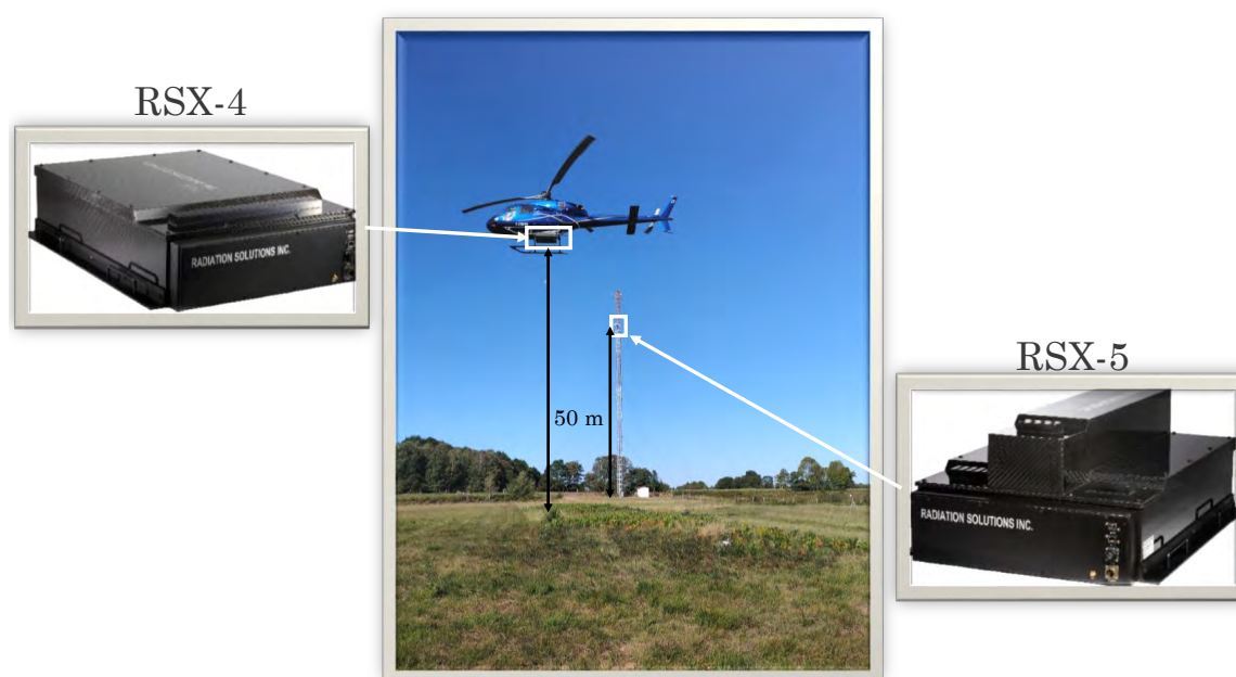
Figure 8.1 – Dispositif de mesure de spectrométrie \gamma embarqué sur un hélicoptère de type Écureuil. Un spectromètre \text{NaI(Tl)} , RSX-4, est utilisé dans le cadre du survol du site P2OA-CRA. Un spectromètre \text{NaI(Tl)} , RSX-5, est installé sur la tour instrumentée à une altitude de 50 mètres.
