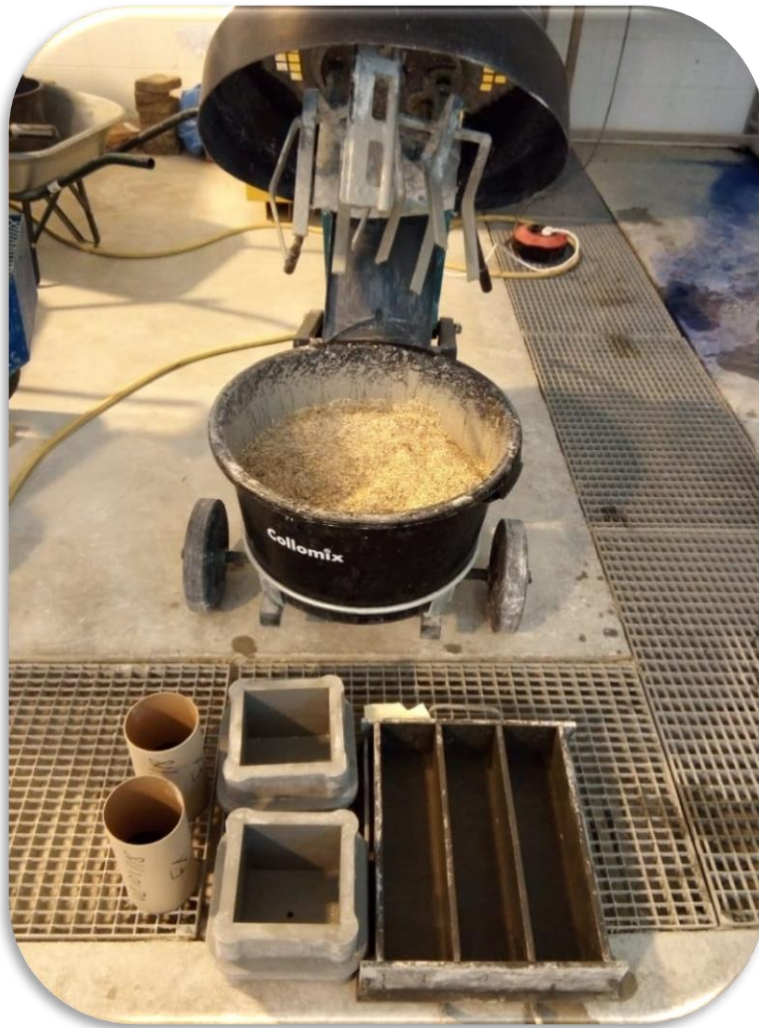
Figure II-6. Malaxage du béton de chanvre
