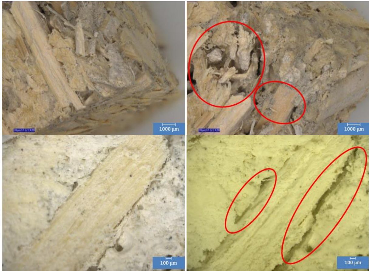
Figure IV-9. Microstructure du béton de chanvre : (à gauche) non vieilli, (à droite) vieilli par immersion/séchage.
