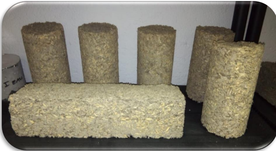
Figure II-7. Pré-conditionnement des matériaux dans une chambre climatique ( T=20^{\circ}\text{C} ; \text{HR}=50\% ).
