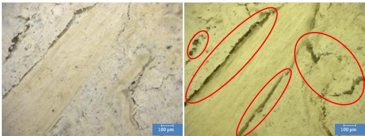
Figure IV-10. Microstructure du béton de chanvre : (à gauche) non vieilli, (à droite) vieilli par immersion/gel/séchage.
