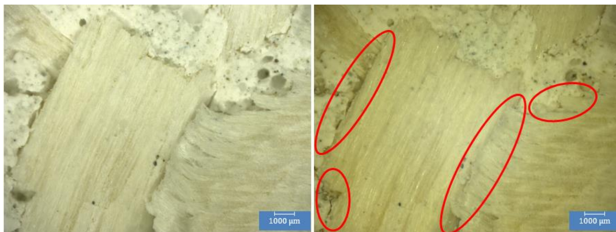
Figure IV-11. Microstructure du béton de chanvre : (à gauche) non vieilli, (à droite) vieilli après l'application du protocole d'humidification/séchage.
