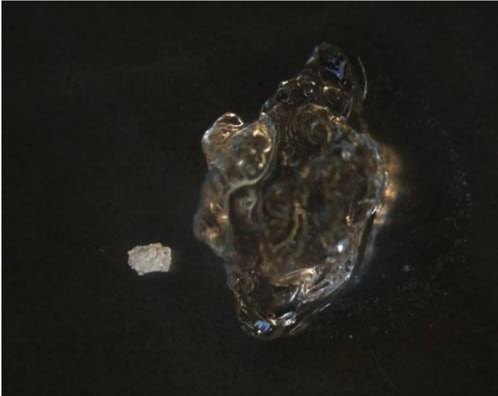
Figure A-1 Polymères super-absorbant à l'état sec (gauche) et à l'état humide (droite) 14
