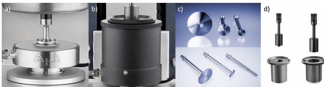
Figure B-16 Systèmes Peltier utilisés au cours de cette thèse : a) Peltier plan, b) Peltier cylindres et diverses géométries : c) cône-plan (dessus), plan-plan (dessous), d) cylindre concentrique (gauche) et double entrefer (droite) 17 .
